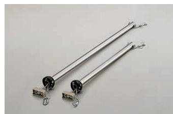
DP-35323 (延長パイプ) ¥3,000 DP-35322 (延長パイプ) ¥2,000 ● 鋼管 シルバーサテン塗装 ● 径 20 長600mm 0.6kg < 35323 > ● 径 20 長400mm 0.4kg < 35322 > ● カリビアファンDP-35203専用 ● 傾斜天井にも使用可能 32 まで > 35323 > ● 傾斜天井にも使用可能 25 まで > 35322 >
